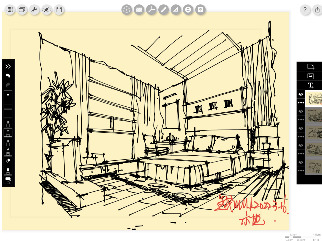
图 6：一张两点透视图的画法过程演示 2（由局部到整体的画法）
